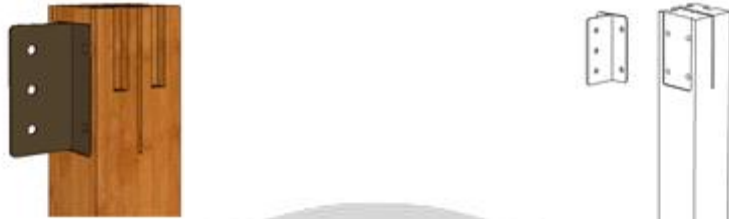
(b) 3개의 연결볼트를 이용한 기둥과 도리의 철물접합
