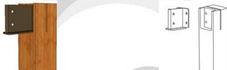
(c) 2개의 연결볼트와 받침재를 이용한 기둥과 도리의 철물접합
