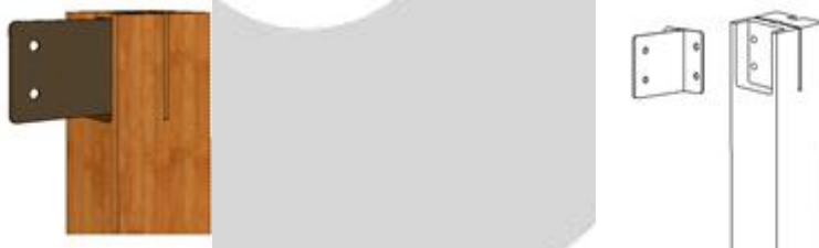
(d) 2개의 연결볼트를 이용한 기둥과 대들보의 철물접합
