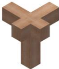
(b) 평주에 보,보아지,장여,도리가 접합된 접합부
