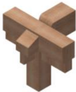
(b) 평주에 보,보아지,장여,도리가 접합된 접합부
