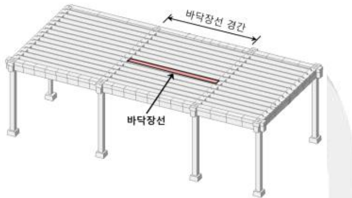
그림 4.7-1 바닥장선의 구성 및 관련 용어
