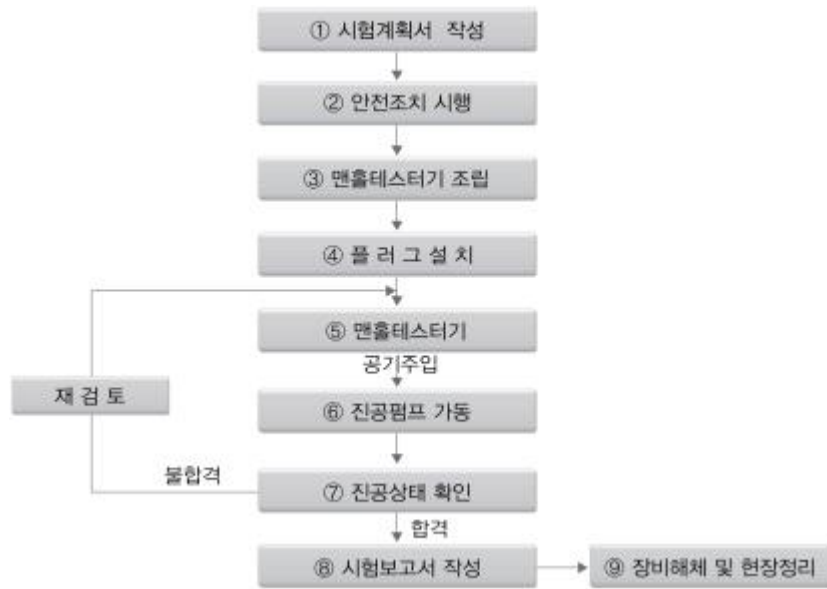
[그림 2-8-8] 맨홀 부공기압(진공시험) 절차모식도
